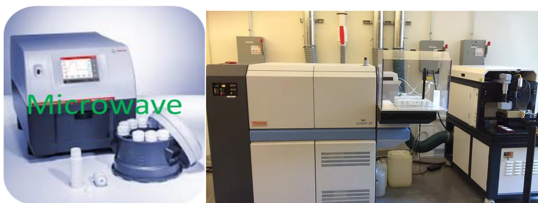
Hình 2.5. Thiết bị phá mẫu (trái) và phân tích kim loại nặng ICP-MS (phải).
