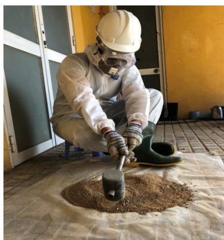
Công tác gia công mẫu đất
