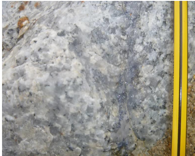
Ảnh 3.2: Molipdenit hạt trung - nhỏ xâm tán trong vi khe nứt của đá granit bị biến đổi sericit hóa, ít muscovit hóa; (NT2303/2) (Ảnh Đỗ Đức Nguyên, 2017)
