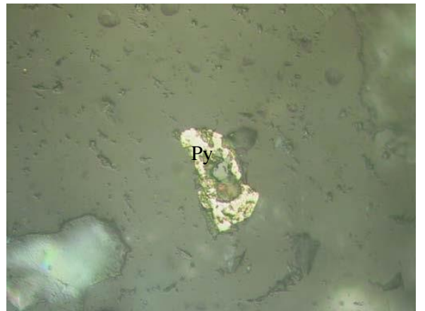
Ảnh 3.7: Pyrotin trong nền đá granit bị biến đổi. (Mẫu KT2304). Nicol (-)100x
