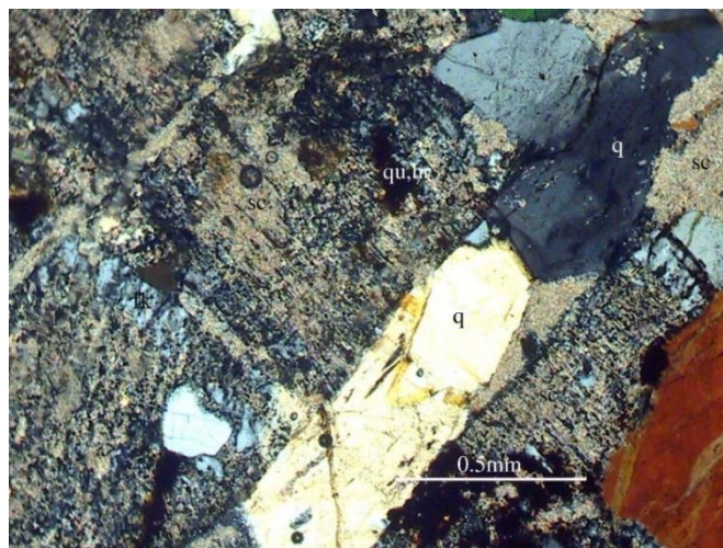
Ảnh 4.10: Đới biến đổi greisen hóa yếu chứa khoáng vật quặng, trong granit porphyr, khu vực xã Đăk Rơ Nga, Đăk Tô, Kon Tum. Nikon(-). fk - felspat, sc - sericit, q - thạch anh, qu - quặng
